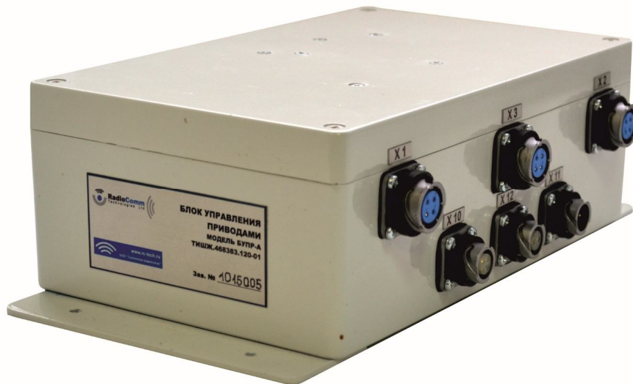
Рисунок 1.2.1.1 – Внешний вид БУПР-А со стороны правой боковой и нижней стенки изделия
